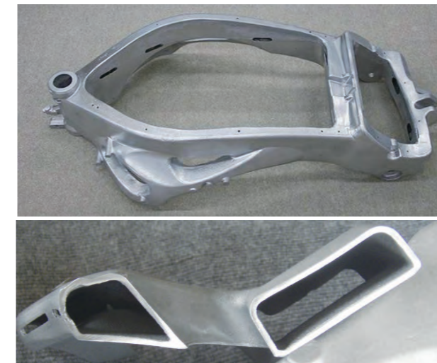
▲中空一体閉鎖構造の砂型で試作された二輪車のフレーム
