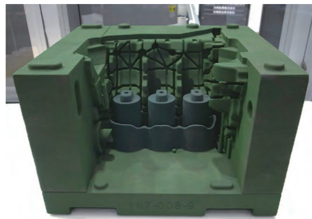
▲3Dプリンタで複雑な形状の造形も実現（自動車のシリンダーブロック）
