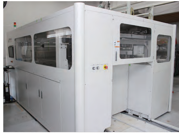
▲開発中の造形装置（能力：5万cc/h）
