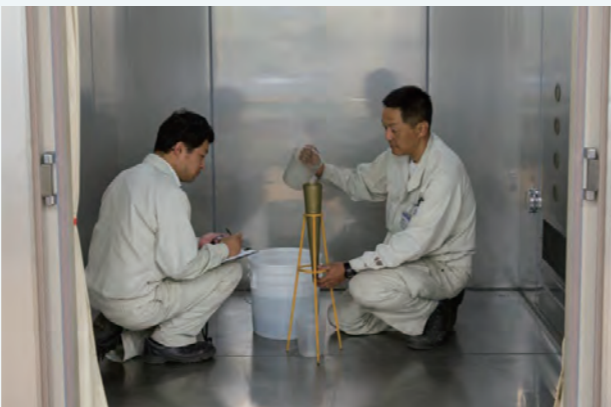
▲モルタルの流動性試験
