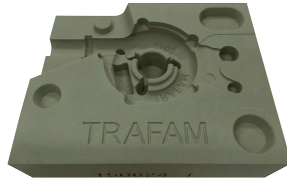
▲3Dプリンタで造形した砂型（自動車のターボチャージャー）
