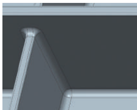
▲パネルは縦1150mm×横1700mm。 厚さ13mmのデッキプレートの下 に高さ190mmの補強リブを格子 状に配置している
