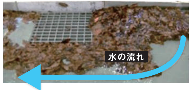
写真4: 落下率が低い落葉の堆積形状
