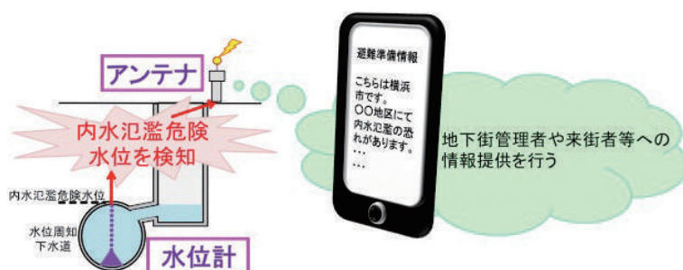
▼マンホールアンテナを活用した水位周知下水道のイメージ
