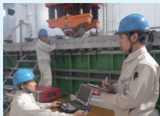
▲輪荷重試験の状況1
