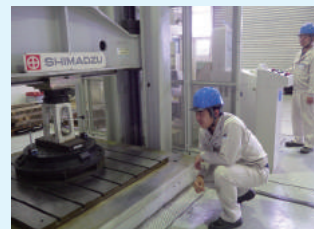
▲マンホールふたの荷重試験
