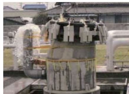
▲マンホールに内圧を加える実験
