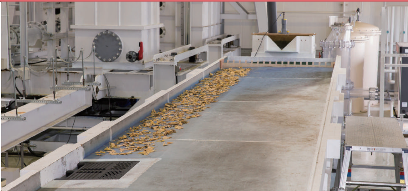
写真5：実規模道路模型（土木研究所の既往研究 ※5 に用いた実験装置を参考にした施設。場所：G&U技術研究センター）
