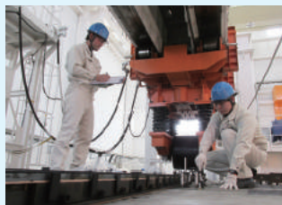
▲輪荷重試験の状況2
