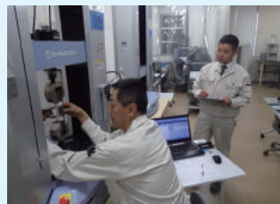
▲プラスチック管材の引張試験
