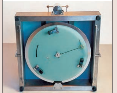
路面に接触する表面。円盤にゴムスライダーが取り付けられている
