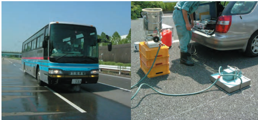
舗装のすべり抵抗値を評価するための装置。すべり抵抗測定車（左）とDFテスター（右）
