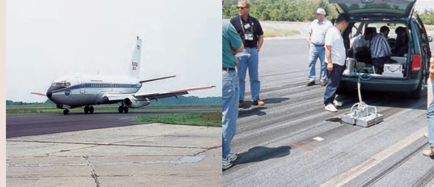
NASAで開かれたすべり抵抗測定の研究会。大型旅客機による実測定（左）とDFテスター測定（右）
