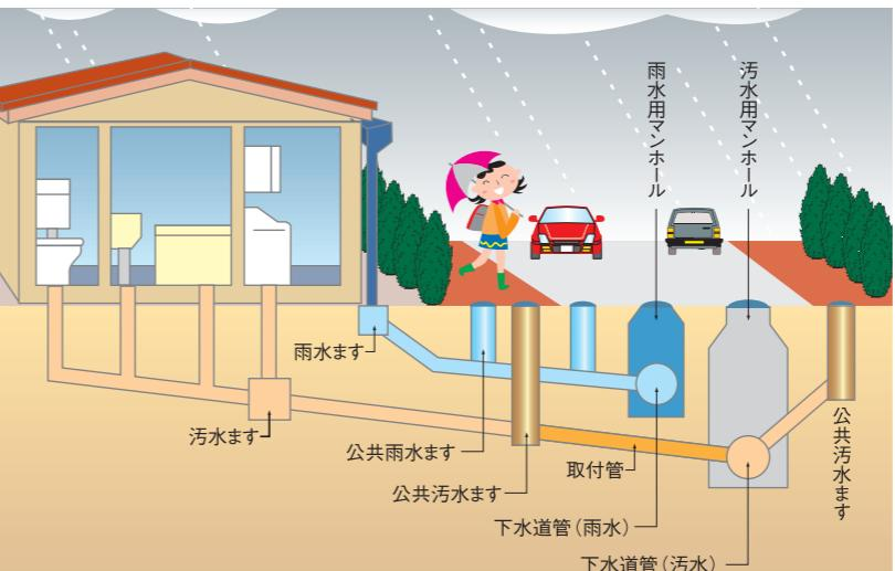
汚水用と雨水用と管路を2つ埋設し、汚水は下水処理場へ、雨水は公共用水域に放流する方式。汚水と雨水を1つの管路で一緒に下水処理場まで送る方式は合流式と呼ばれ、東京都や大阪市など早くから下水道事業に着手した自治体が多い。
