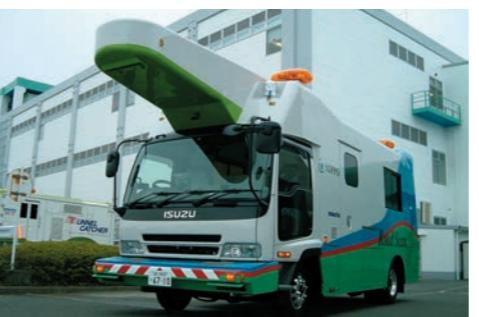
写真2 路面性状測定車（ロードスキャナー）
