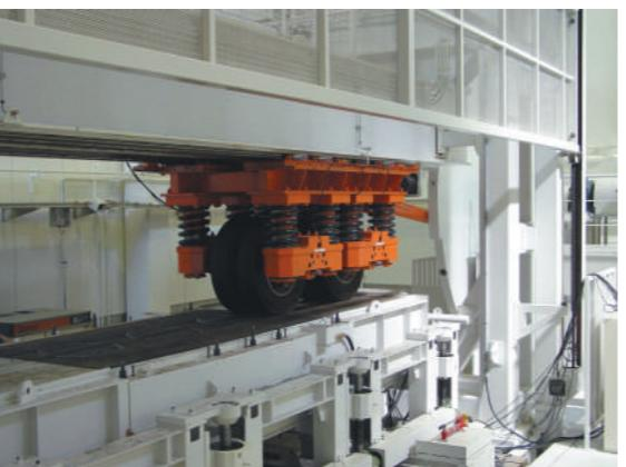
写真5 輪荷重走行試験機によるガタツキの検証
