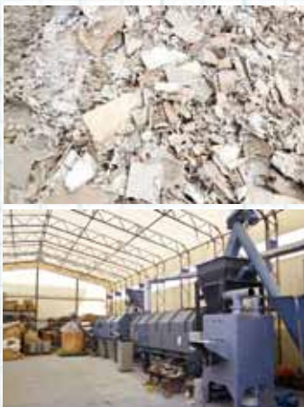
〈右上〉回収された廃石膏ボード 〈右下〉紙と分離された廃石膏を焼成処理し、再生半水石膏を製造する機械 〈左上〉焼成処理された再生半水石膏 (写真提供 佐藤研一)
