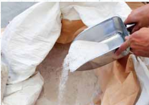
〈右上〉回収された廃石膏ボード 〈右下〉紙と分離された廃石膏を焼成処理し、再生半水石膏を製造する機械 〈左上〉焼成処理された再生半水石膏 (写真提供 佐藤研一)
