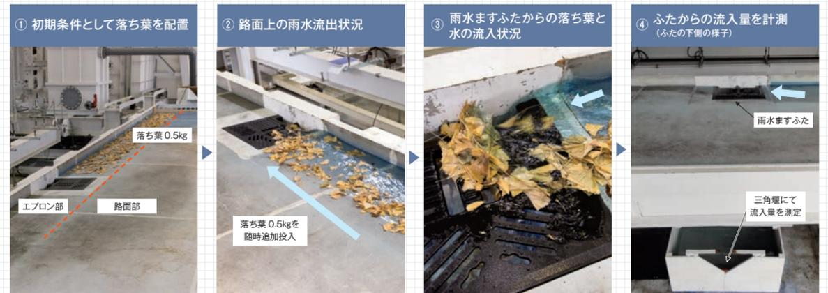
落ち葉詰まり対策を施した雨水ますふた A は、流出してきた水がおおむねふたから流入する。落ち葉詰まり対策を施していない雨水ますふた B は、落ち葉が詰まることで排水性能が低下し、排水できなかった雨水(グラフの網掛け部分)は下流へ流れ出てしまった。
