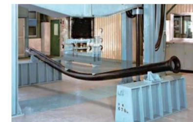
▲ダクタイル鉄管の外圧試験 (写真提供：日本ダクタイル鉄管協会)
