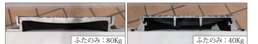
▲片状黒鉛鋳鉄製(左)から球状黒鉛鋳鉄製(右)へと材質進化したマンホールふたの比較(断面写真)
