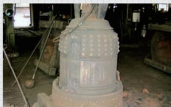
鑄込みの2日後、鑄型を取り外す。土でつくった型を壊してしまうため、同じ梵鐘がつかれることはない。
