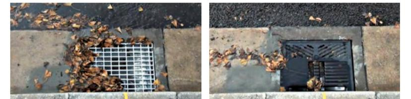
写真2: 鋼製グレーチングふたと改良型雨水ますふたの堆積状況(流出量ピーク値 2.6ℓ/s)
