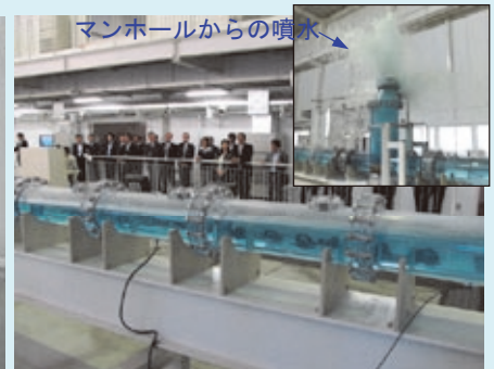
マンホールからの噴水 下水道管路の水理モデル実験
