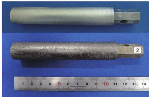
▲試験体の変化（上：埋設前、下：1年埋設後）
