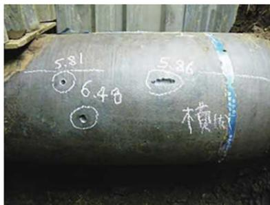
▲管体の表面に腐食孔を発見
